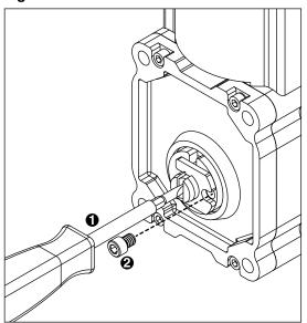
17. Plug in gear motor (Fig. 53).
