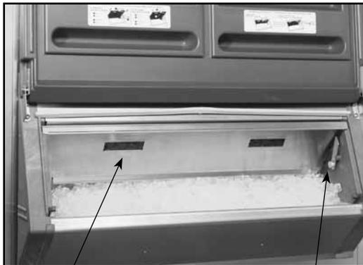
Verklumptes Eis lässt sich **durch** den SmartGATE-Eisschild hindurch mit der optional als Zubehör erhältlichen Eisschaufel sicher auflockern. Das gelöste Eis verbleibt **hinter** dem SmartGATE-Eisschild.
